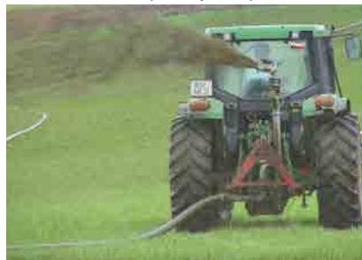
Schwenkdüsenverteiler mit Gülleverschlauchung
